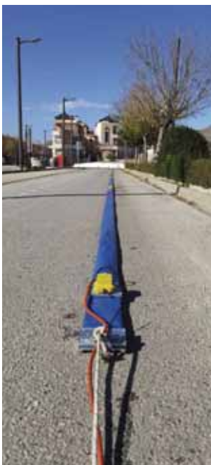
DAÑOS POR TERREMOTOS. En la imagen principal, un integrante del grupo de investigación golpea el suelo con un mazo para provocar ondas que permiten estudiar el suelo. Al lado, grupo de científicos durante la caracterización del suelo en Santa Fe (Granada). Debajo, manguera llena de sensores para seguir el recorrido de las ondas hasta una profundidad de treinta metros.
