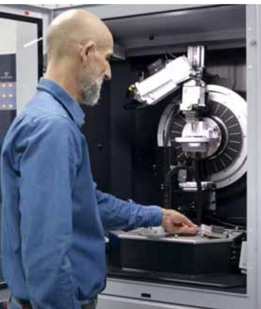
**CEMENTOS.** García Aranda muestra el instrumento con el que hará las tomografías de rayos X para detallar el proceso de endurecimiento de los cementos. Sobre este texto, algunas imágenes detalladas del proceso.
