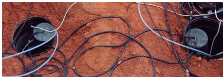
ELECTORREMEDIACIÓN. En la imagen principal, ensayo en laboratorio para atraer contaminantes con electricidad. Al lado el investigador Rubén López-Vizcaíno. Debajo, imágenes en detalle del pozo de electrolito y los electrodos empleados en el proceso. Debajo, esquema de cómo actúa la electrorremediación en suelos contaminados.
