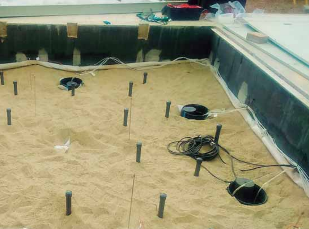
ELECTORREMEDIACIÓN. En la imagen principal, ensayo en laboratorio para atraer contaminantes con electricidad. Al lado el investigador Rubén López-Vizcaíno. Debajo, imágenes en detalle del pozo de electrolito y los electrodos empleados en el proceso. Debajo, esquema de cómo actúa la electrorremediación en suelos contaminados.
