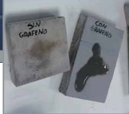
Demostraciones realizadas en la UCAM con el nuevo hormigón con grafeno.
