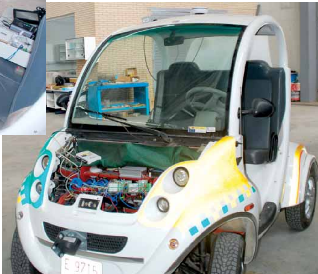
El equipo de la Universidad de Almería ha incorporado todo tipo de sensores a este vehículo para que pueda funcionar de forma autónoma con total seguridad. De momento, la imagen del coche eléctrico es algo espartana, pero es temporal, mientras ultiman los dispositivos tecnológicos que harán funcionar a este coche eléctrico, que también ejercerá de almacén energético.
