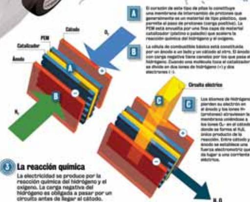
El corazón de este tipo de pila lo constituye una membrana de intercambio de protones que generalmente es un material de tipo plástico, que permite el paso de protones (iones positivos). La PEM está atravesada por una fina capa de material catalizador (platino o platino) que acelera la reacción química del hidrógeno y el oxígeno.
