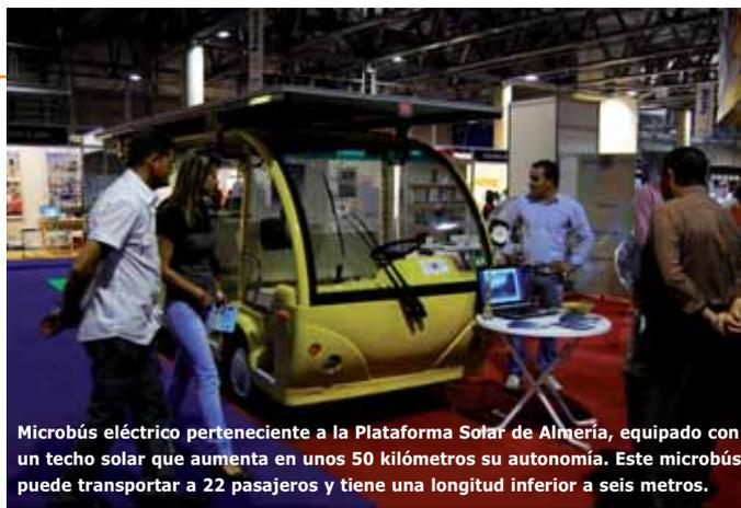
Microbús eléctrico perteneciente a la Plataforma Solar de Almería, equipado con un techo solar que aumenta en unos 50 kilómetros su autonomía. Este microbús puede transportar a 22 pasajeros y tiene una longitud inferior a seis metros.
