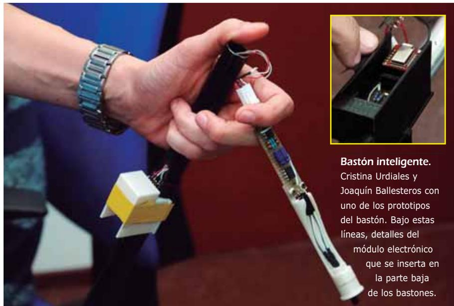
**Bastón inteligente.** Cristina Urdiales y Joaquín Ballesteros con uno de los prototipos del bastón. Bajo estas líneas, detalles del módulo electrónico que se inserta en la parte baja de los bastones.
